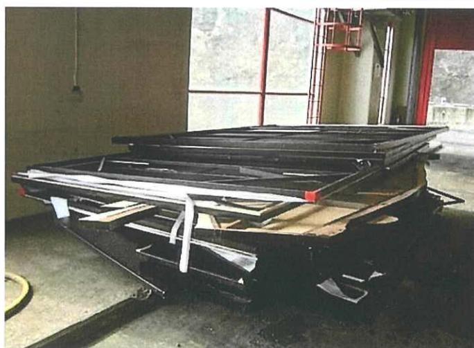
處理方法：在棄置前，必須對有關廢棄物作適當的預處理，將可重用的物料作（如金屬）拆解及回收，避免對垃圾焚化中心的運作造成影響。而可燃的廢棄物需切割成符合有關規定的尺寸（直徑不能超過 200 毫米）及長度（不能超過 3 米長），再運往垃圾焚化中心處理。
